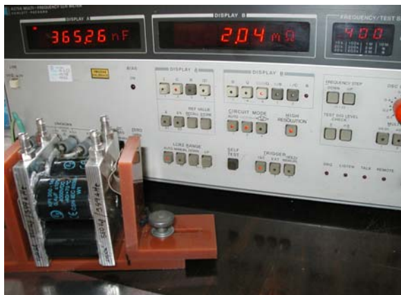
Měření ESR KPI300-148 0,4µF při 400kHz
