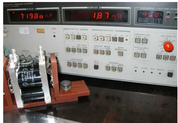
Měření ESR KPI300-148 0,8µF při 400kHz
