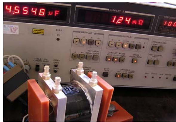
Měření ESR KPI300-195 při 100kHz
