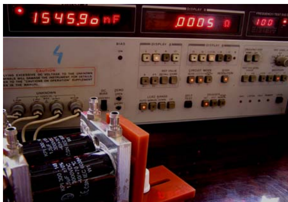
Měření ESR KPI300-148 1,5µF 3kVDC při 100kHz
