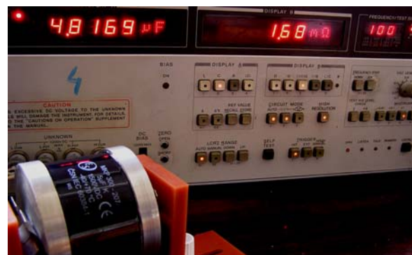
Měření ESR KPI300-195 při 100kHz
